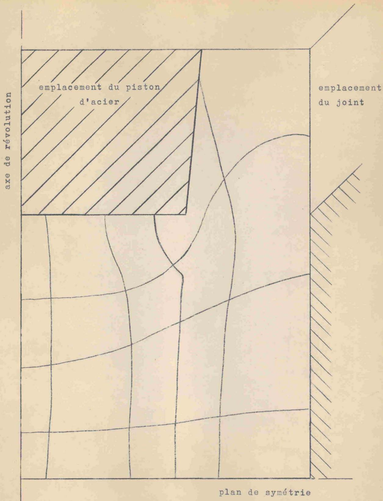
Fig. 3.9 - Déformations dans la cellule d'après les photos 3.6 (montage des disques plats) et 3.8 (montage des cylindres concentriques).
